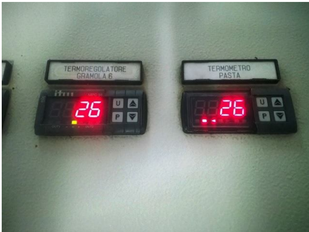
Fig. n. 56 –Controllo processo, fase di estrazione olio: Verifica temperatura di gramolazione
