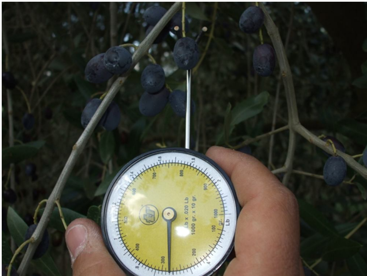
Fig. 40 – Dinamometro per misurazione resistenza al distacco olive
