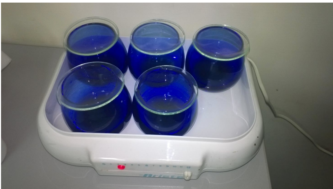
Fig. 63 – Dispositivo di riscaldamento dei campioni
